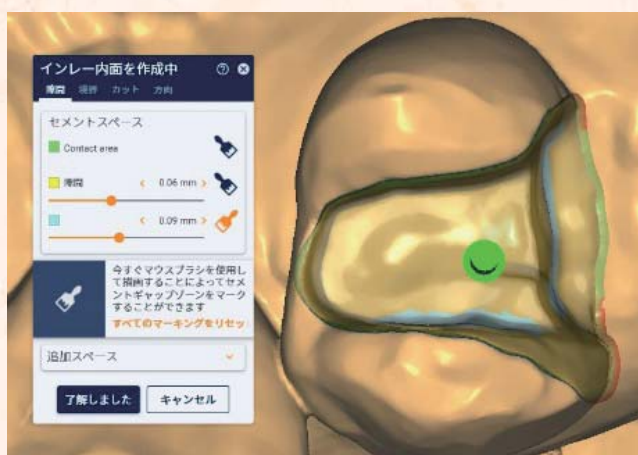
図11. セメントスペース設定は、2面インレーなら全体を0.05mm～0.07mm程度にして+ \alpha 追加している。
