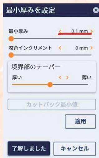
図14. 製品の安全性の観点から0.4mmが最小設定であるが、カットバック最小値を選択すると0.1mmまで薄くできる。裂溝部分や隣接面などの厚みが確保できていれば、マージンが薄くても特に問題なく加工できる。
