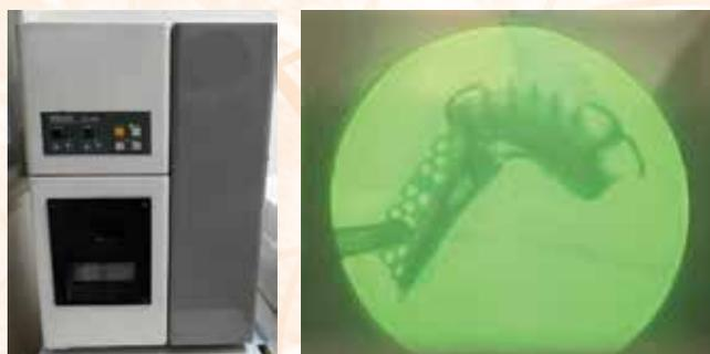
Fig.5 X線透視装置で铸造欠陥を検査 ※矢印箇所
