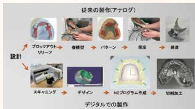
Fig.6 アナログ技工とデジタル技工のワークフロー比較<sup>3)</sup>
