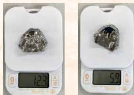
Fig.3 左がコバルトクロム床：比重8.2g/cm<sup>3</sup>、右がチタン床：比重4.4g/cm<sup>3</sup>
