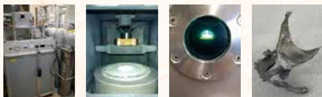
Fig.4 左から、チタン铸造機・真空溶解炉・溶解中・铸造後
